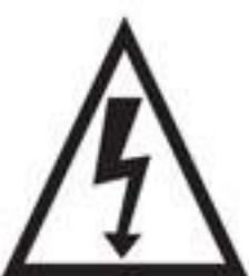
Simbolo indicante la presenza di alta tensione, senza isolamento elettrico, pericolosa.
